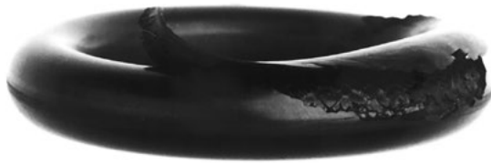
Abb. 10.7 Teilweise geschälter O-Ring
