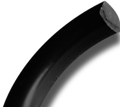
Abb. 10.12 Schäden durch Abrieb als einseitige Abflachung an der Innenseite erkennbar
