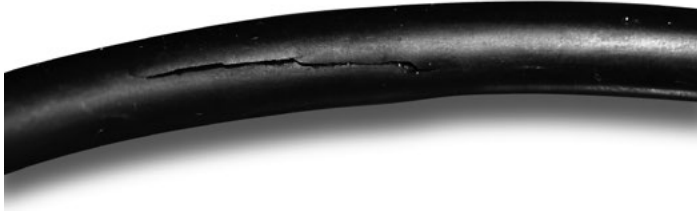
Abb. 10.11 Oberflächenzerstörung durch explosive Dekompression
