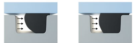
Abb. 10.3 Bei höherem Druck wird ein größeres O-Ring-Volumen in den Dichtspalt gedrückt. Für Abhilfe sorgt hier ein Stützring, der die Spalteinwanderung verhindert.
