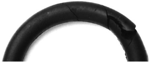
Abb. 10.10 Verdrehter O-Ring mit Einschnitten in der O-Ring-Oberfläche
