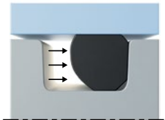
Abb. 10.2 Bei Druckaufbau verhält sich der O-Ring wie eine inkompressible Flüssigkeit und erhöht proportional zum Druck seine Anpresskraft
