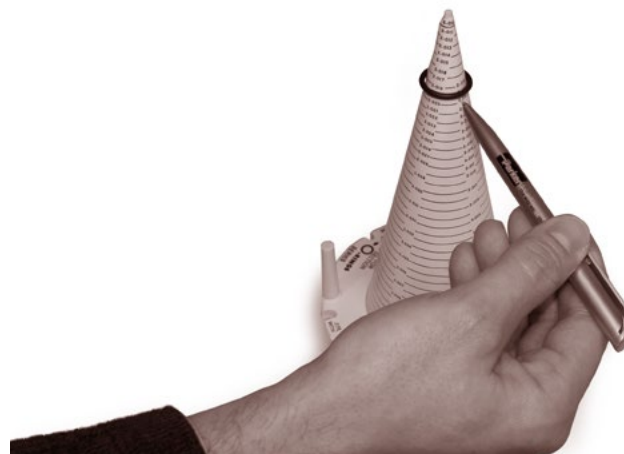
Abb. 5.4 Bestimmung der Größe mit dem Messkegel
