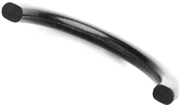
Abb. 10.8 Schadensbild durch hohe bleibende Verformung (Compression Set)
