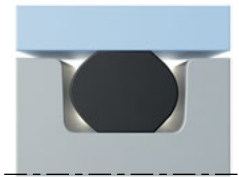
Abb. 10.1 Der O-Ring dichtet aufgrund seines elastischen Verhaltens im verpressten drucklosen Zustand zwischen zwei Dichtflächen
