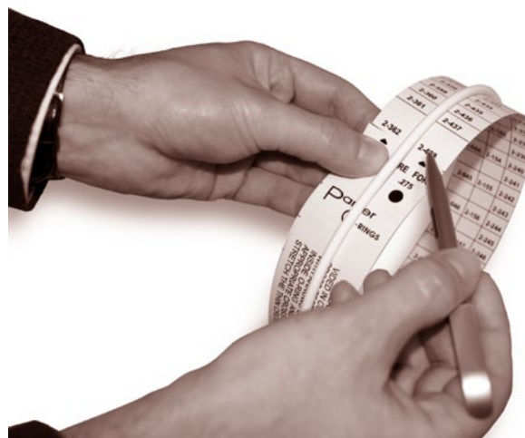
Abb. 5.5 Bestimmung der Größe mit dem Maßband
