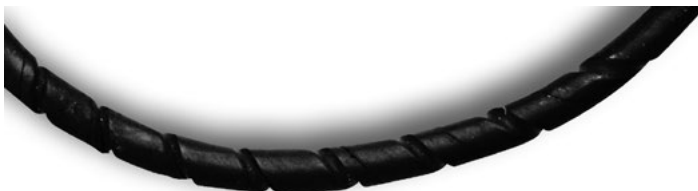
Abb. 10.9 Verdrehter O-Ring mit spiralförmigen Markierungen
