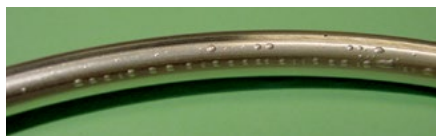
Abbildung 1: Blasen (Blister) auf einer Dichtung mit Standard-Silberbeschichtung nach 1000 Stunden Luftkontakt bei 260 °C (500 °F)
