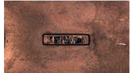
Abbildung 2: Ergebnisse einer Flächenverschleißprüfung "Stift auf Fläche" für Legierung 718 mit TriCom- und Tribaloy T-800-Beschichtung.
