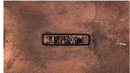
Abbildung 2: Ergebnisse einer Flächenverschleißprüfung "Stift auf Fläche" für Legierung 718 mit TriCom- und Tribaloy T-800-Beschichtung.
