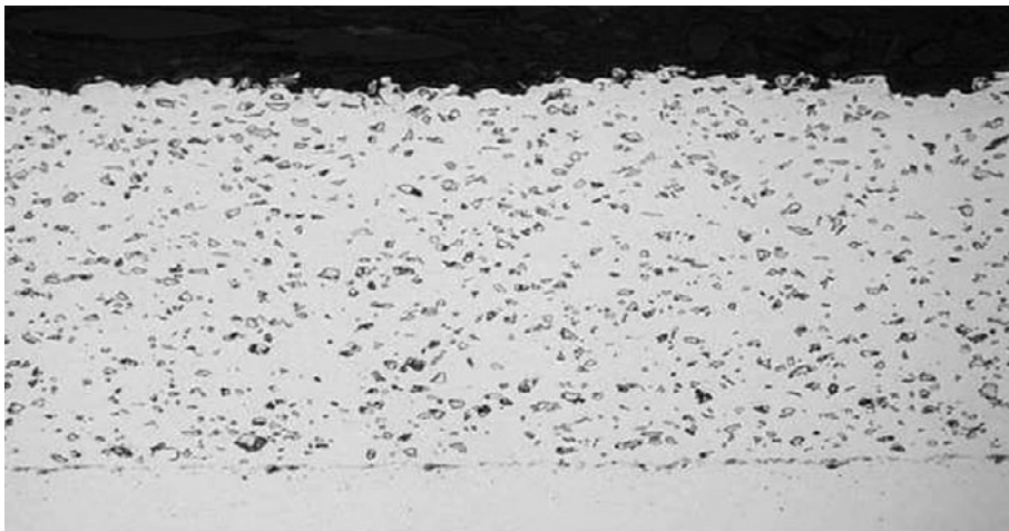
Abbildung 1: TriCom ist eine Verbundbeschichtung, die aus einer Kobaltmatrix und einer Verstärkungsphase aus Chromkarbid besteht.
