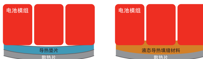
图11: 接触面厚度不均匀界面接触示意图—固态导热垫片 (左) vs 液态导热填缝材料 (右)
