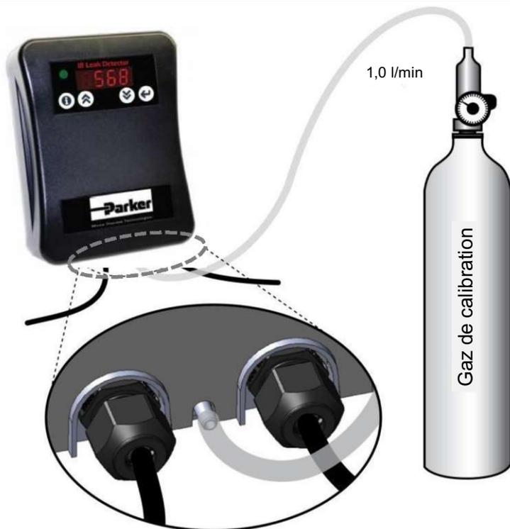
Figure 16. Utilisation d'un gaz de calibration
