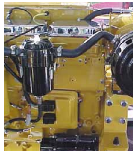
La figura que sigue: (izquierda) Motor marino Cummins QSM11 con corte CCV (derecha) Motor marino Caterpillar 3196 con el sistema Racor CCV/AF.
