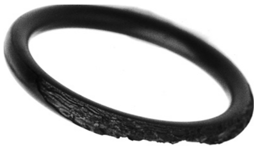
Fig. 10.6 Joint torique extrudé
