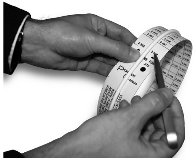
Fig. 5.9 Détermination des dimensions du joint torique à l'aide du ruban de mesure
