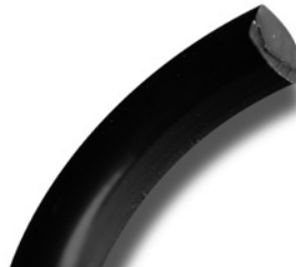
Fig. 10.12 L'usure peut être observée sous la forme d'un aplatissement d'un côté du joint torique
