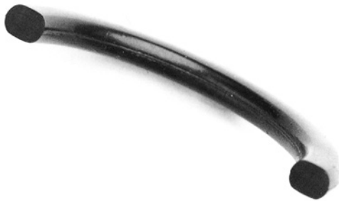
Fig. 10.8 Type de dommage provoqué par une déformation rémanente élevée après compression
