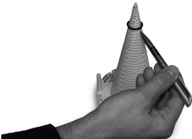
Fig. 5.8 Détermination du numéro de taille 2-xxx avec le cône de mesure
