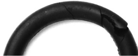
Fig. 10.10 Joint torique torsadé avec coupures en surface
