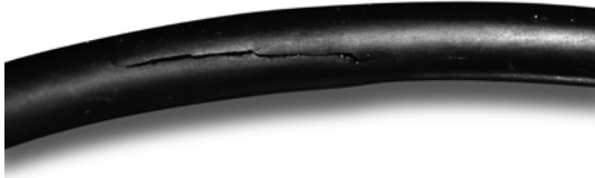
Fig. 10.11 Joint torique endommagé à la suite d'une décompression explosive
