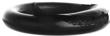
Fig. 10.7 Joint torique pelé
