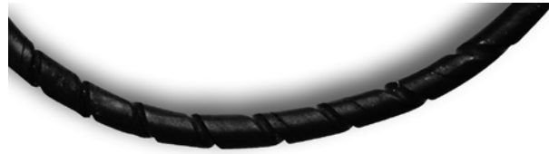
Fig. 10.9 Joint torique torsadé avec marques en spirale
