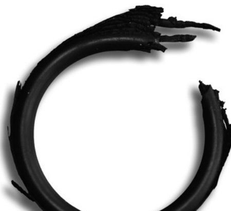
Fig. 10.5 Joint torique extrudé
