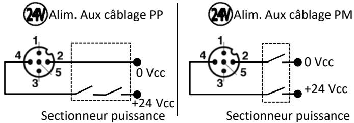
**Note: L'usage de ce module depuis une source d'alimentation OSSD avec test pulse ne peut pas être possible à moins que l'impulsion soit ajustable à plus de 8ms. Pour plus d'information sur ce cas d'utilisation, merci de contacter le Service Client PARKER**
