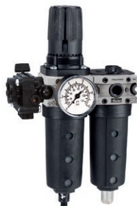
Kombination aus Absperrschieber + Filter-Regler + Nano-Nebelöler (50mg/m³) Filterelement 5 µ, Regler 8 bar + Manometer und Befestigungswinkel
