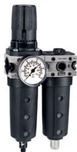
Kombination aus Filter-Regler + Nano-Nebelöler (50mg/m³) Filterelement 5 µ, Regler 8 bar + Manometer und Befestigungswinkel
