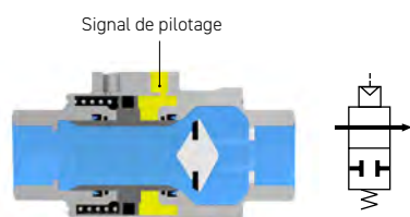
État piloté (vanne ouverte)
