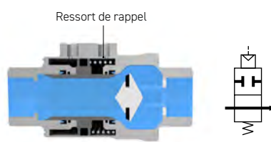
État repos (vanne ouverte)
