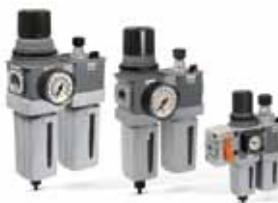
Il sistema Parker Global di trattamento dell'aria compressa è disponibile con tre dimensioni del corpo e filettature BSPP o NPT per ogni requisito. Filtri, regolatori, filtri/regolatori e lubrificatori sono disponibili con una vasta gamma di opzioni standard. Le singole unità possono essere assemblate facilmente in varie combinazioni grazie ai connettori modulari brevettati.
