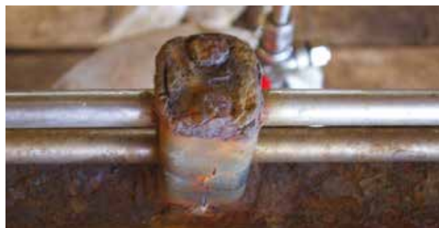
Corrosion caverneuse à l'interface tube/collier.
