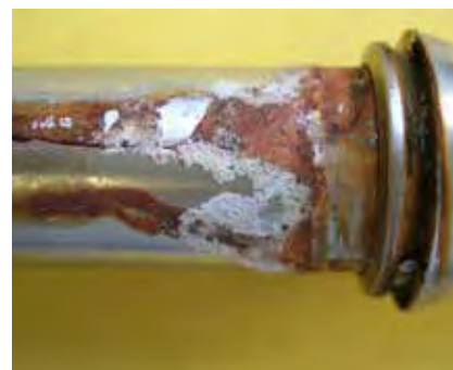
Produit bas de gamme. La corrosion se forme suite à un procédé de durcissement de mauvaise qualité appliqué à la bague arrière.
