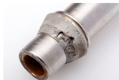
Figure 1. Ces raccords double bagues à compression, fabriqués en acier inoxydable 316, ont été retirés d'une conduite en 6Mo qui était en service offshore pendant neuf mois. Ces photos montrent les éventuelles difficultés liées aux décisions prises en rapport avec les raccords uniquement pour des raisons de coût.
