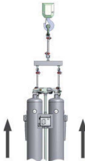
II: Ustawianie za pomocą dźwigu
