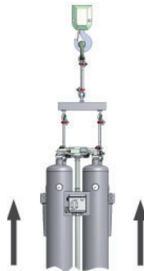
II: Mise en place avec grue
