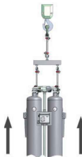
II: Colocación con grúa
