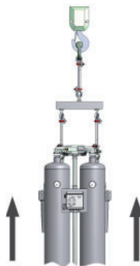
II: Ustavení jeřábem
