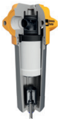
Dwarsdoorsnede van een coalescentiefilter
