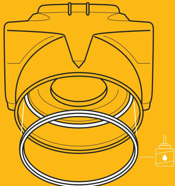
Asegúrese de lubricar la junta tórica y las roscas con un gel ácido sin petróleo apropiado.
