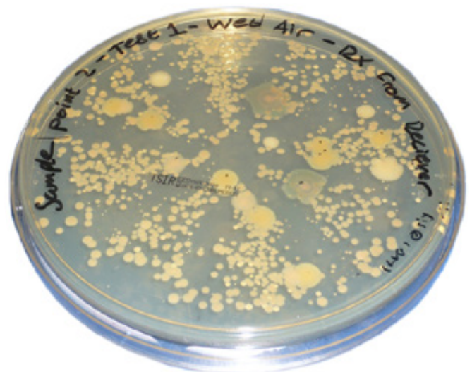
Agarplatte mit mikrobiologischem Wachstum aus Druckluftprobe
