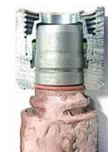
L'UPTC après un test de vibration extrême
