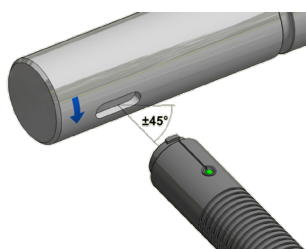
Arbre en rotation : Mesure de vitesse sans contact.
