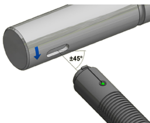
Rotierende Welle: Berührungslose Drehzahlmessung.
