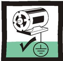
Le moteur du variateur doit être raccordé à une prise de terre adaptée.
