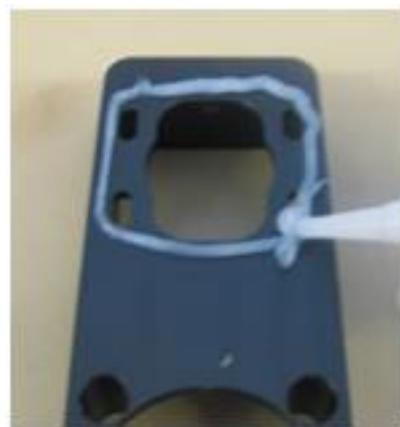
Abbildung 32: Parallelgehäuse ETH32 ... 80 für IP65 vorbereitet
