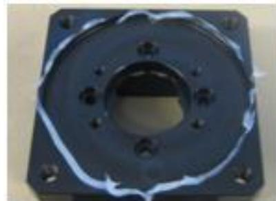
Abbildung 31: Flansch für IP65 vorbereitet
