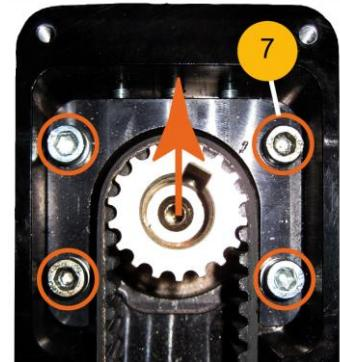
Abbildung 28: Schrauben zur Fixierung der Antriebeinheit ETH032...ETH080
