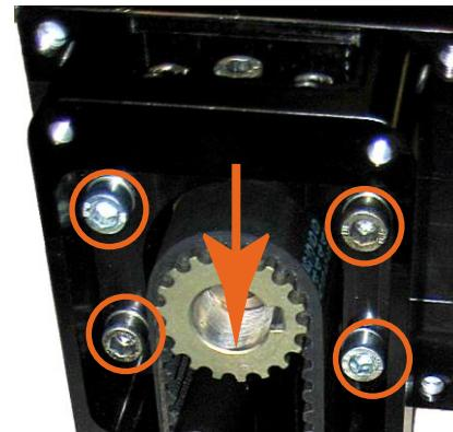
Abbildung 22: Zahnriemenspannung lösen
