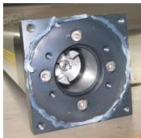
Abbildung 30: Flansch für IP65 vorbereitet
