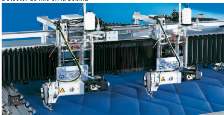
Máquinas automáticas con doble cabezal para una mayor productividad
