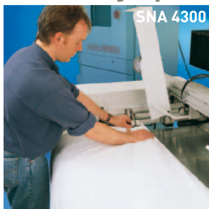
Preparación de la alimentación automática de material
