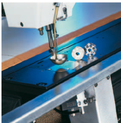
Canette de grande capacité avec tête de piquage robuste
