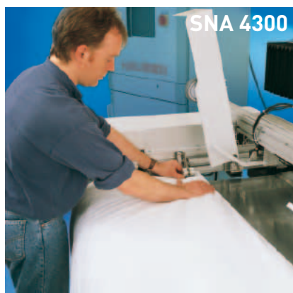
Préparation de l'insertion automatique du panneau
