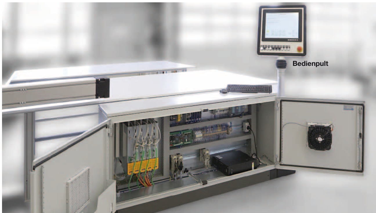
Das Herz eines Steppsystems: Schaltschrank mit volldigitalen Servoantrieben.
