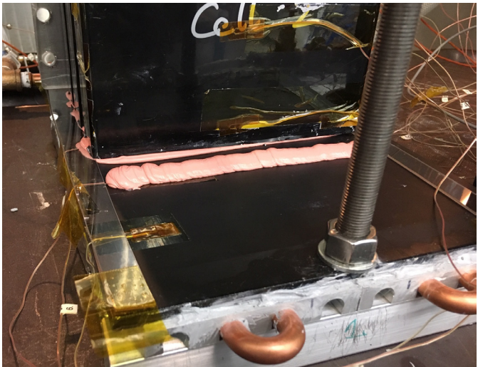
图4: 使用洛德填缝胶将电芯组装到冷却板上
