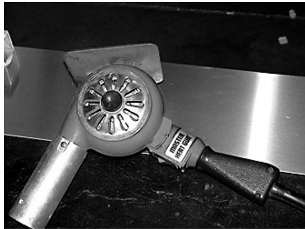
Use la pistola de aire caliente para retirar la pieza adherida
