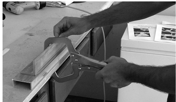
Sujete las piezas después de aplicar el adhesivo
