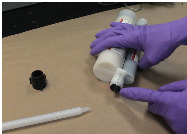
Retire y deseché los tapones plásticos que se encuentran en los orificios de salida
