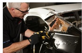
**Sugerencia:** Si utiliza adhesivos a base de resina epoxíca, como Fusor 208B o Fusor 2098\*, administrelo siempre en ambas bridás de adhesión y, posteriormente, siga con la aplicación del adhesivo. Si utiliza un adhesivo acrílico, como 108B, 108BE\*\* o 112B, no lo coloque en las bridás.
