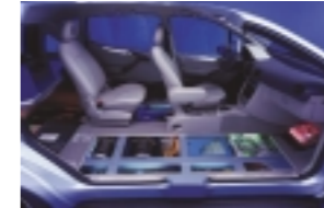
Im Unterboden des Fahrzeugs sind sowohl das komplette Brennstoffzellensystem als auch die Wasserstofftanks untergebracht. Somit steht im Fahrzeuginnenraum und im Kofferraum das volle Platzangebot zur Verfügung.
