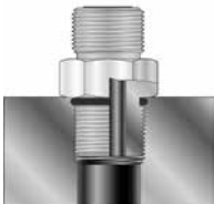
圖12 - BSPP帶沉孔和O型圈密封
