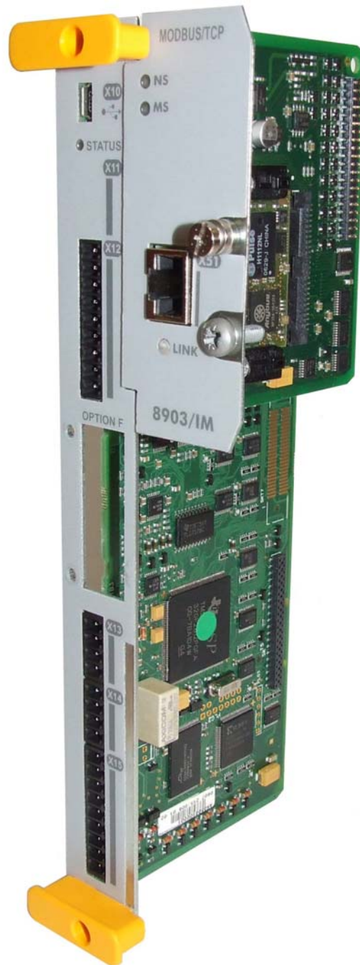
Abbildung 5: 890 Reglerkarte mit Tech-Card bestückt
