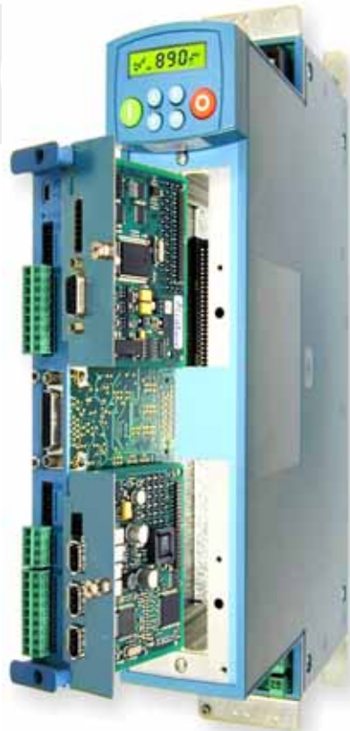
Abbildung 2. Zeigt die Reglerkarte bei der Bestückung mit Optionskarten
