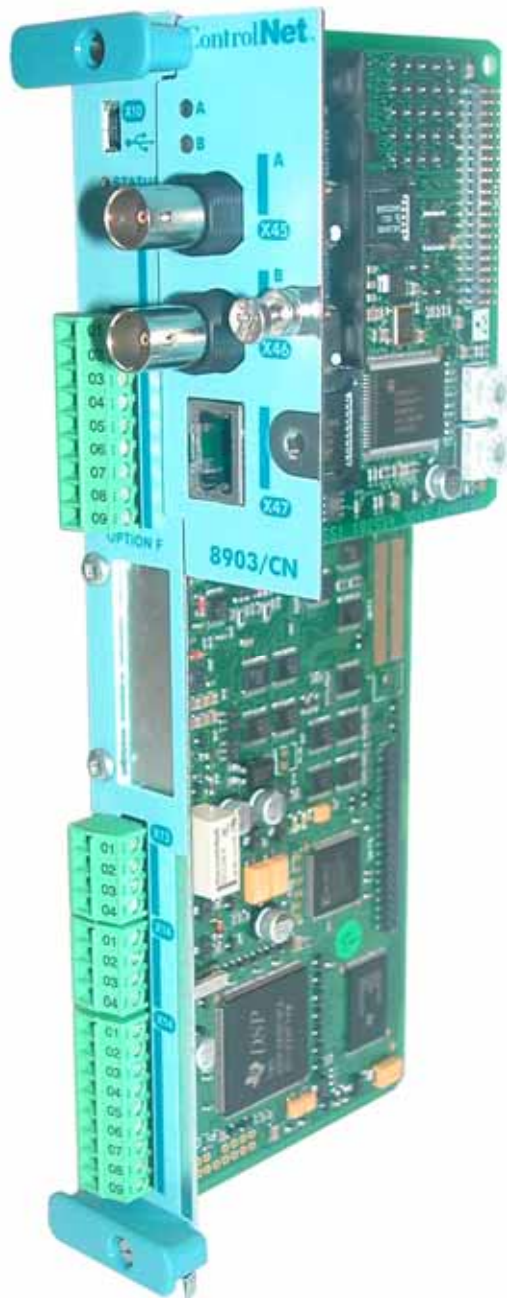
Abbildung 5. 890 Reglerkarte mit TechCard bestückt
