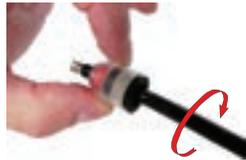
Zentrieren und drehen Sie den Gas-Block-Verbinder bis zum Anschlag auf das Glasfaserkabel.
