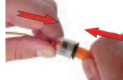
3. Drücken Sie den Verbinder fest und gerade über die Dichtung bis zum Anschlag auf den Schlauch.
