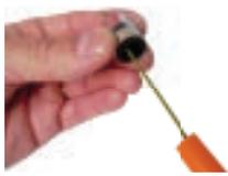
1. Stecken Sie den Gas-Block Verbinder auf das Glasfaserkabel.
