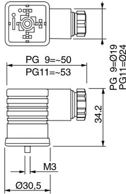
\* EN 175301-803 (neu) korrespondiert mit (alt) DIN 43650.
