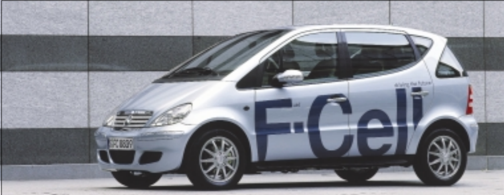
Der "F-Cell" auf Basis der A-Klasse von Mercedes Benz ist bereits die zweite Fahrzeuggeneration, die DaimlerChrysler mit Brennstoffzellentechnik auf die Straße bringt.
