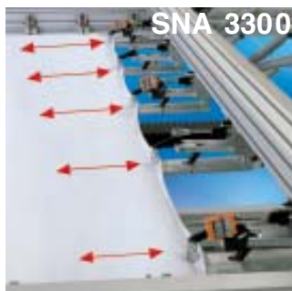
Автоматический захват, натяжение и выравнивание швейного материала на выходе
