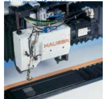
Мощная швейная головка для тяжелых / толстых материалов
