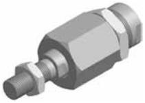
Flexo-Kupplung zur gelenkigen Montage der Kolbenstange. Die Flexo-Befestigung dient zum Ausgleich axialer Winkelfehler im Bereich von ±4°.
