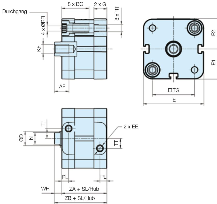
P1PG...DS Doppeltwirkend mit geführter Kolbenstange
