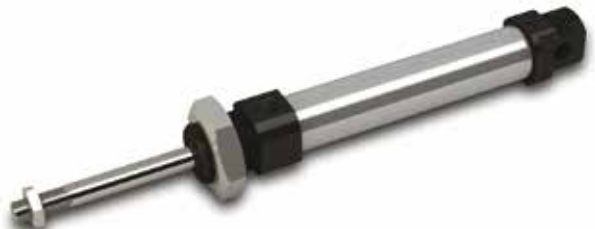
Einfachwirkend, durch Feder ausgeschobene Kolbenstange
